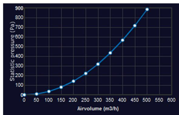
Die Luftmengen werden pro Filterzylinder angegeben. Die empfohlene maximale Leistung pro Zylinder beträgt 156 m<sup>3</sup>/h.
